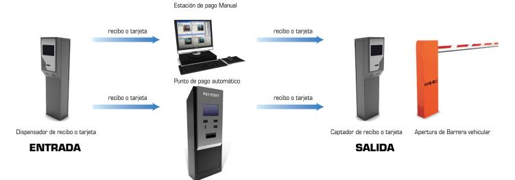
Opción Estación de pago Manual: Antes de retirar el vehículo, el cliente presentará en la CAJA su tarjeta de ingreso para que el Módulo de Cobro realice el cálculo de tarifa. Una vez realizado el pago, se validará la tarjeta y el sistema emitirá mediante una impresora térmica una factura de pago.
